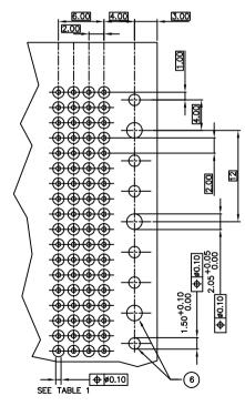
RECOMMENDED PC BOARD LAYOUT, COMPONENT SIDE.
